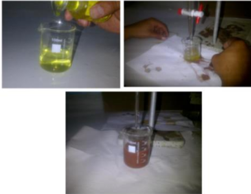
Proceso de titulación \text{AgNO}_3 , para la determinación de cloruros.
