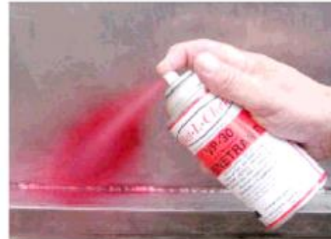
2. Aplicación del penetrante
