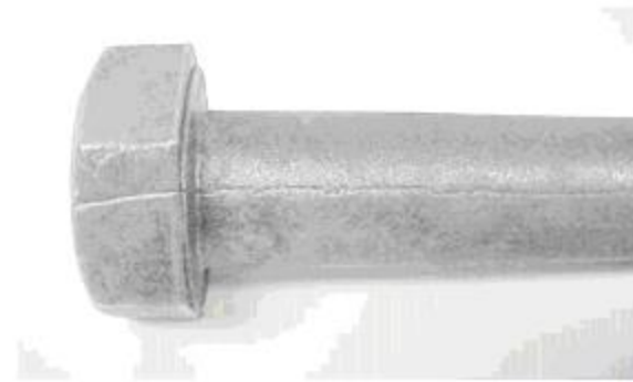
Fractura en bulón
