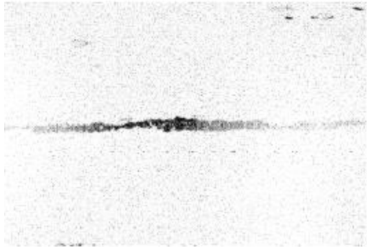
Inclusión de Silicato en una barra de acero
